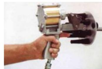
Der im Teller verbleibende Fingerkopf kann leicht ausgestoßen werden.
