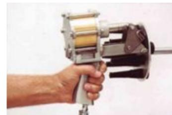
Den Auslöser drücken. Das Messer schließt und schneidet den Finger ab. Den Auslöser loslassen. Das Messer öffnet sich wieder und der Fingerabschnitt fällt durch den Cutter.
